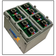
高汎用FlashCOREプログラマエンジン、超高速LumenXプログラマエンジンを選択可。混載可。
