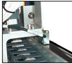
モータ内蔵ロータリエンコーダによる予想精度ではなく、1μm分解能リニアエンコーダによる位置実測
