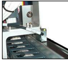
モータ内蔵ロータリエンコーダによる予想精度ではなく、1 \mu\text{m} 分解能リニアエンコーダによる位置実測
